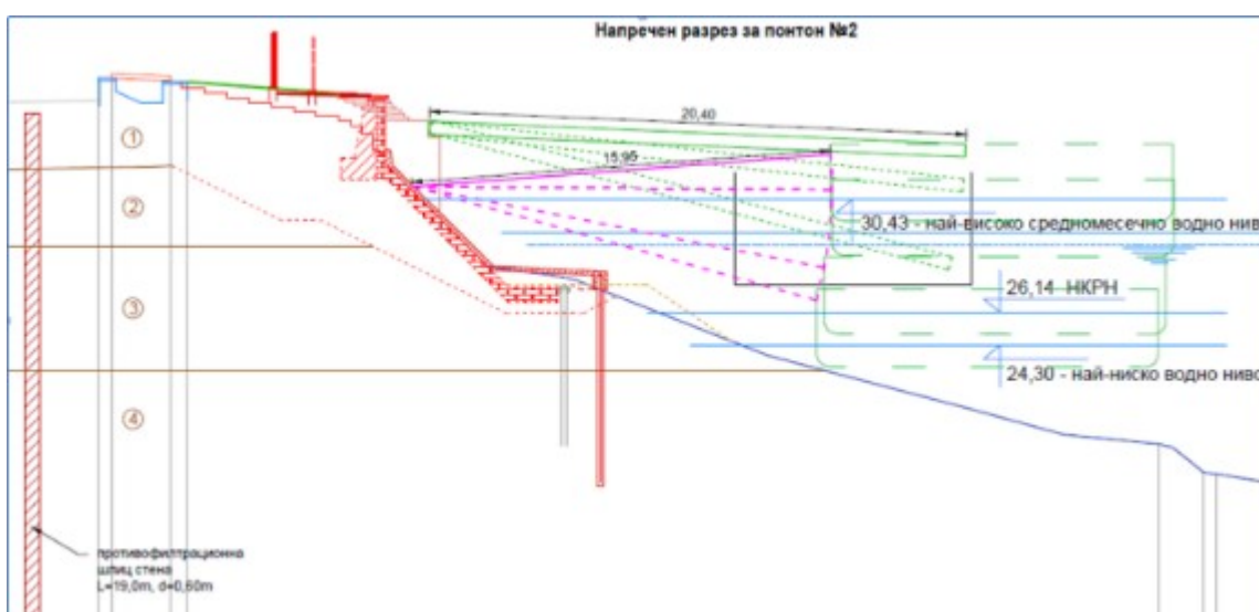
Фигура 43: Разрез през Кейова стена на корабно място №2
