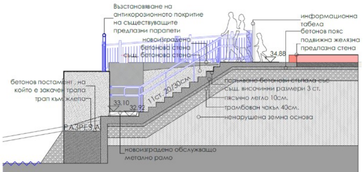
Фигура 49: Разрез през Кейова стена на корабно място № 5
